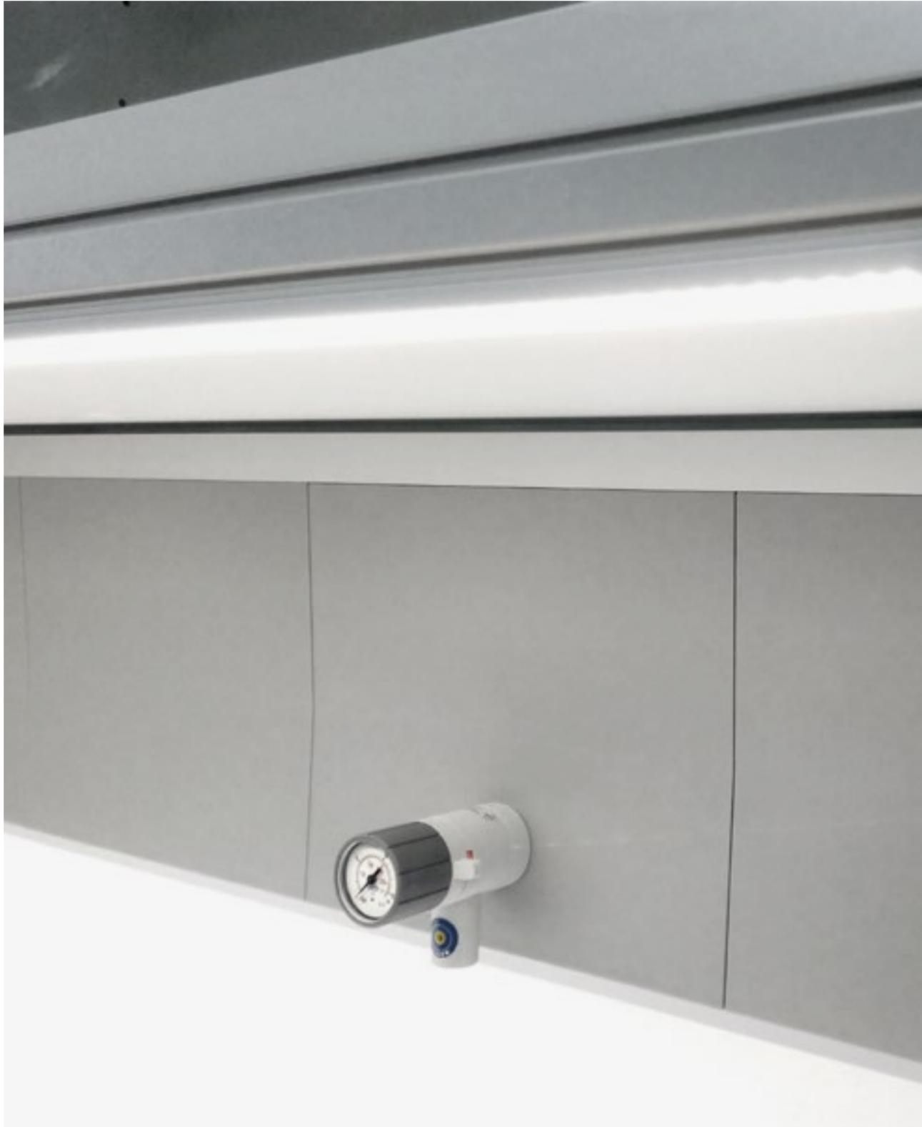
Cuerpo construido en aluminio y difusor en Policarbonato, la tira de luminaria se encuentra en el interior de ésta. La luminaria tiene una reproducción cromática hasta CRI94. Dispone de 120 leds por metro.
