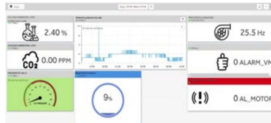
El sistema presenta una desviación de menos de un minuto en la visualización de datos, pero el sistema es independiente de la red informática del edificio, permite un acceso multiusuario de forma deslocalizada y el coste de ampliación de nuevos equipos es muy inferior al de un SCADA.
