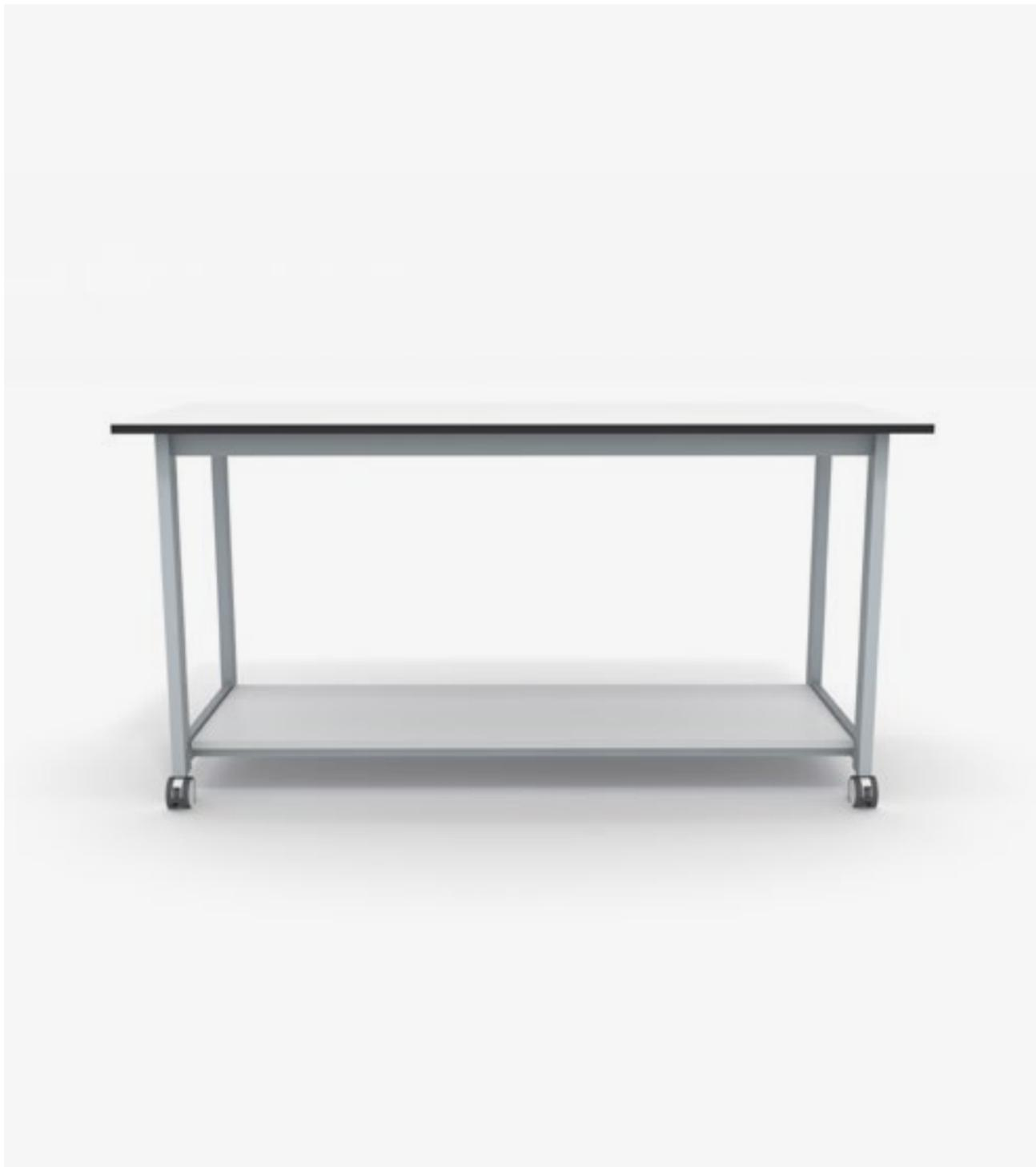
Construida con estructura de tubo de acero laminado en frío y encimera de laminado de alta presión con resistencia química (HPL) de 20mm de espesor. Estos modelos disponen de 4 ruedas de nylon (dos con freno) de gran resistencia. En su parte inferior puede disponer de un entrepaño o estante, hueco, o hueco combinado con espacio para almacenamiento pudiéndose incorporar una gran gama de unidades de almacenaje disponible (véase capítulo 4).
